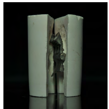
Raffreddato il cilindro, la fusione viene liberata dal rivestimento.
