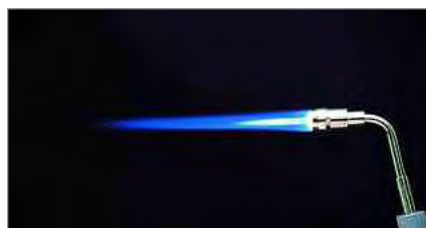
Kit per fusione con cannello e bombole di propano e ossigeno.
