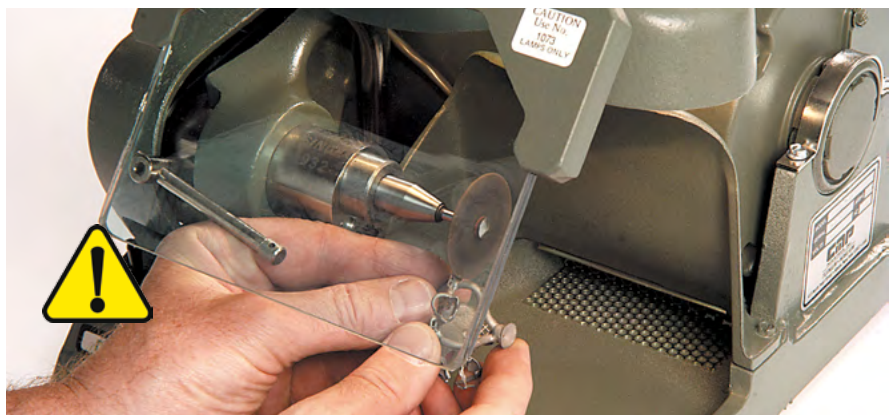
Rifinitura con la "Rapida": si tratta di un procedimento piuttosto rischioso, da riservare solo agli operatori più esperti.
