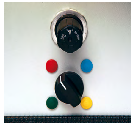
Sabbiatrice a 4 sabbie, con regolatore di pressione e commutatore posti al suo interno.
