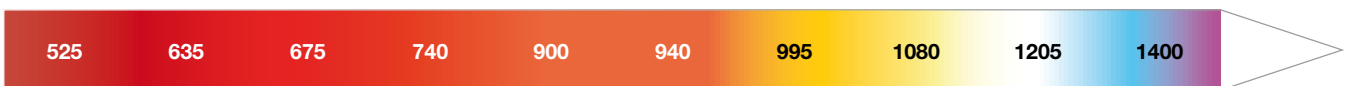
Temperatura della fiamma in base al colore secondo le indicazioni dei Vigili del Fuoco.
