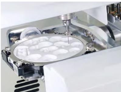
Scansione, disegno CAD e realizzazione del dispositivo con sistema CAM.
