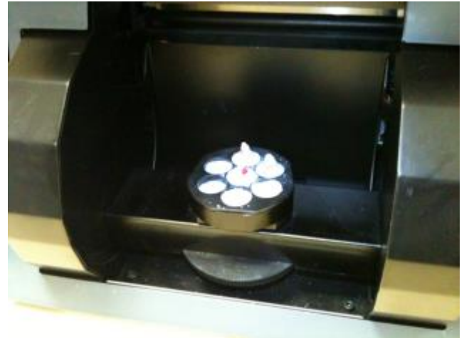
Scanner D900 con i monconi sul perno Multi-Die passivo
