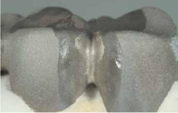
Lasciar raffreddare lentamente l'oggetto da saldare. Rimuovere la massa da rivestimento per saldatura. Sabbigare accuratamente gli ossidi ed i residui di flux (con  $Al_2O_3$  da 50 o 100  $\mu m$ ). Leghe nobili possono essere decappate (PCT AScid).
