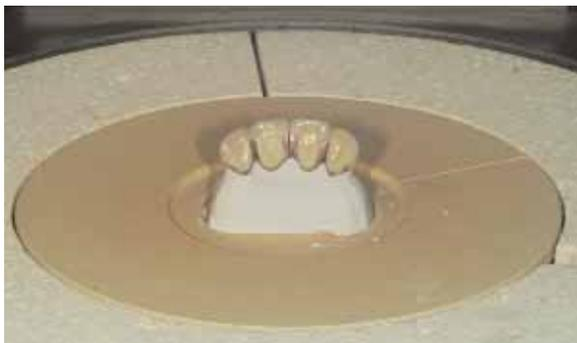
E' necessario raggiungere la temperatura di lavoro della saldatura. Può essere superiore di max. 50°C affinché la saldatura confluisca nella fessura di saldatura. La temperatura di lavoro della saldatura tuttavia deve essere almeno 50°C inferiore all'ultima temperatura di cottura della ceramica.
