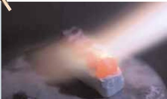
A seconda delle leghe da unire si scelgono le saldature con l'adeguata temperatura di lavorazione. Saldature dentali devono essere resistenti in cavo orale e possedere una composizione simile alle leghe da unire.
