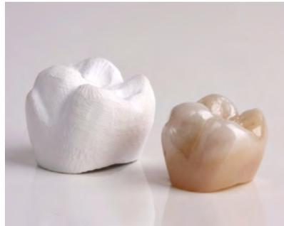
Fasi di realizzazione di una corona in zirconia (subito dopo la fresatura CAM e dopo la sinterizzazione). È evidente la variazione dimensionale cui è soggetta la corona durante la lavorazione.
