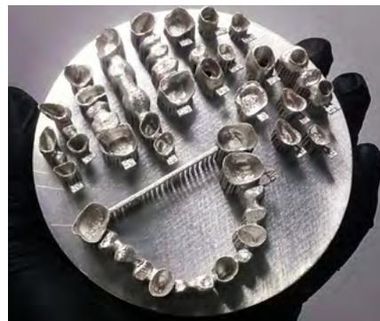
Il procedimento stampa 3D/laser melting avviene per addizione, depositando (o fondendo) il materiale per strati successivi, fino ad ottenere il dispositivo ultimato.
