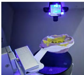
**Scansione dell'impronta.** Il modello virtuale è ottenuto dalla scansione di un'impronta generalmente in elastomero. Alcuni scanner prevedono già la possibilità di scansionare le impronte dual arch in un'unica soluzione.
