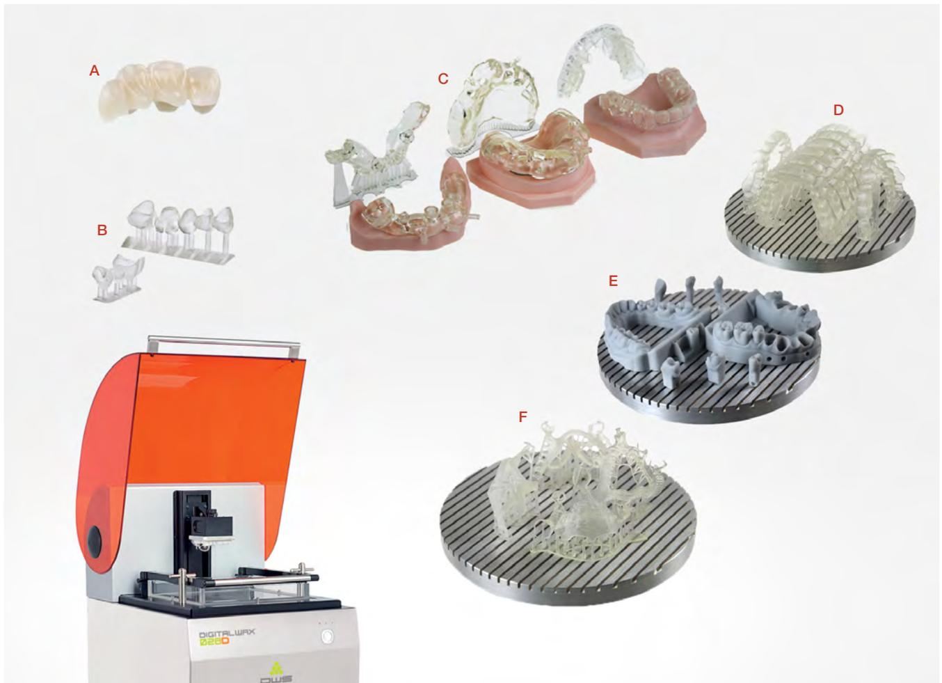
Con le stampanti 3D si possono realizzare una serie di dispositivi in resina materiali plastici e materiali calcinabili: **A**. dispositivi provvisori; **B**. modellazioni CAD calcinabili per la successiva fusione; **C**. ausili chirurgici di vario tipo; **D**. bite e mascherine (anche per terapie ortodontiche); **E**. modelli in resina, anche con monconi sfilabili e sistemi di articolazione; **F**. scheletrati calcinabili da fondere successivamente in metallo.
