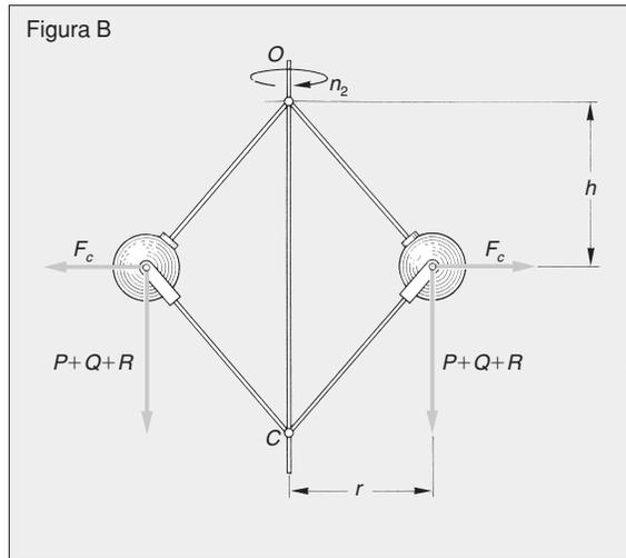
Considerando anche le resistenze passive  $R$  applicate al collare, se il collare tende a innalzarsi a seguito di una diminuzione del momento resistente, il regolatore non interviene fino alla velocità  $\omega_2$  che ne caratterizza il grado di insensibilità; si ottiene:
