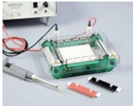
**Figura 1** Dispositivo per elettroforesi. Il recipiente contiene una soluzione salina nella quale viene immerso il supporto su cui è disposto il campione da analizzare. Il campo elettrico è generato dai due elettrodi.
