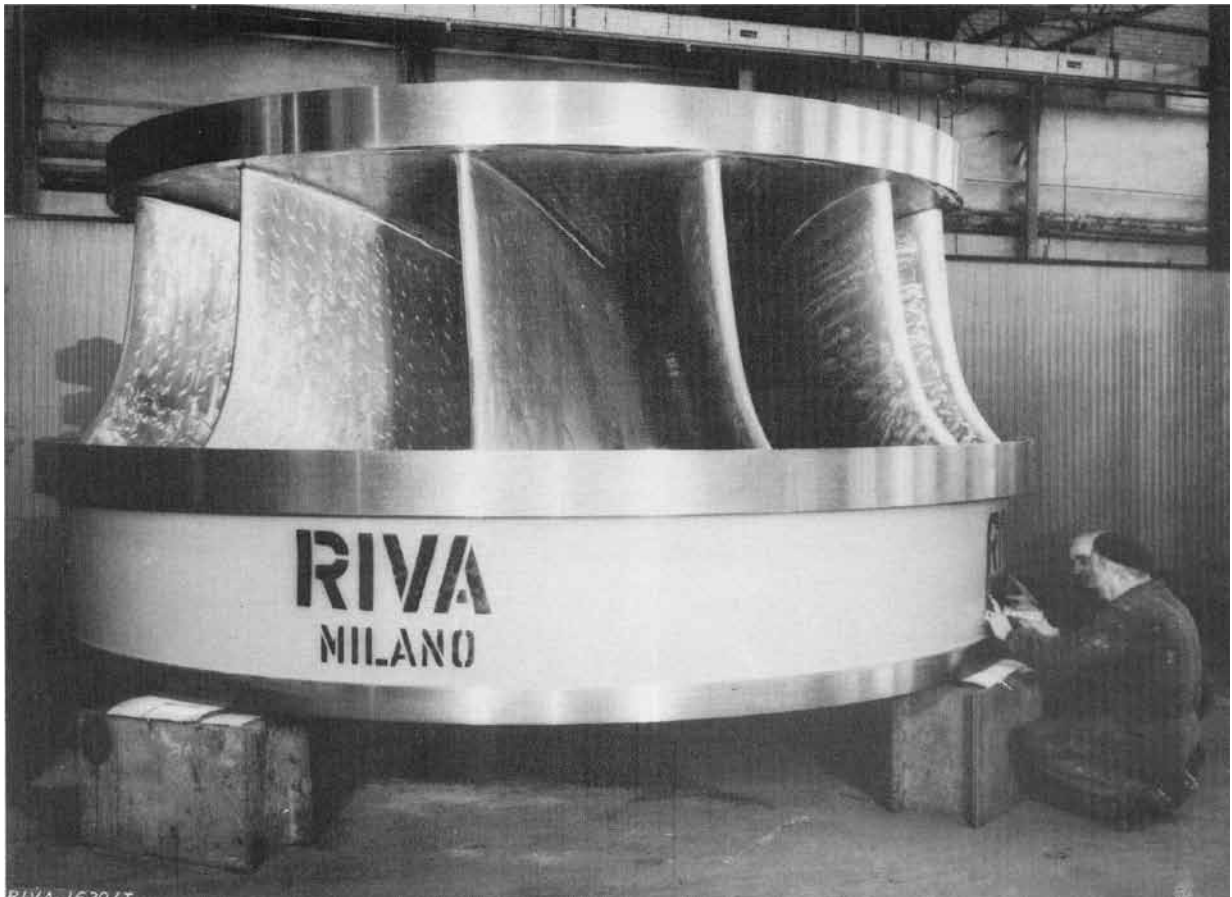
2 Un'altra girante per turbina tipo Francis adatta per utilizzare cadute relativamente basse; la girante ha un diametro di 4,20 m e un peso di 34 tonnellate. Sono chiaramente visibili i condotti a sezione variabile ricavati entro la palettatura mobile (Riva-Calzoni S.p.A.-Milano).
