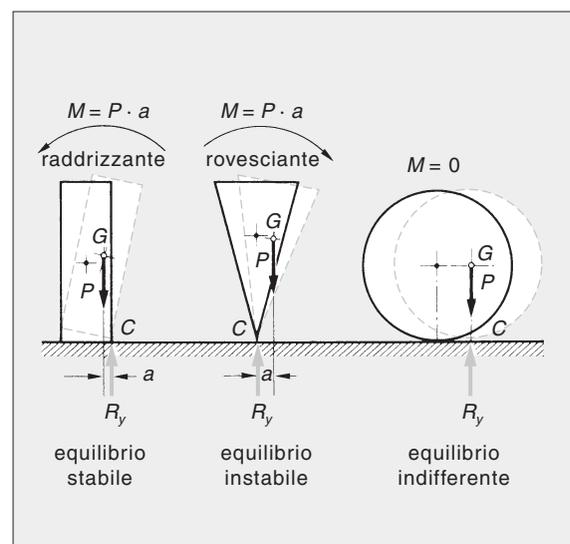
Un corpo incernierato soggetto al proprio peso è in equilibrio quando la forza peso ha una retta d'azione che passa per la cerniera. L'equilibrio è *stabile* se la cerniera si trova sopra il baricentro del corpo, *instabile* se la cerniera si trova sotto il baricentro e *indifferente* se la cerniera coincide con il baricentro.
