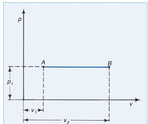
**1** Trasformazione a temperatura costante nel diagramma  $p-v$
