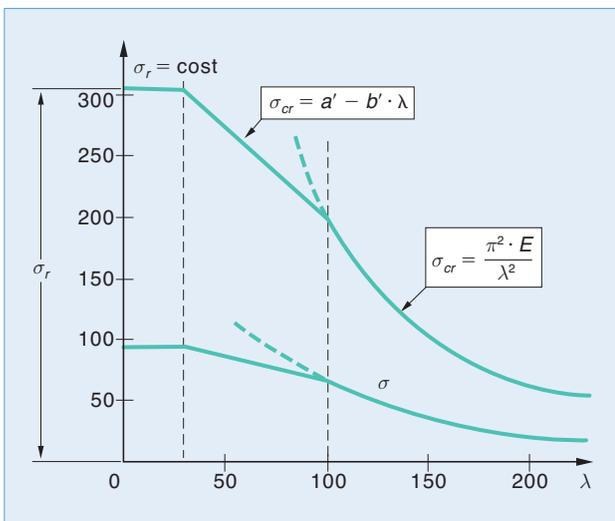
3 Diagramma completo del carico di punta.
