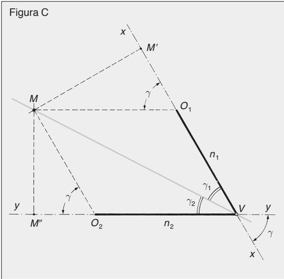
Se gli assi degli alberi non sono paralleli ma concorrenti, si utilizzano **ruote coniche** (figura C).
