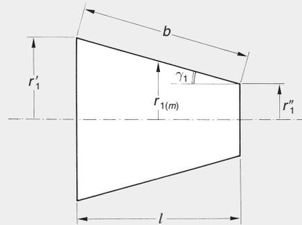
Si ricavano i valori dei due raggi e quindi tutte le altre caratteristiche geometriche delle ruote (figura D).
