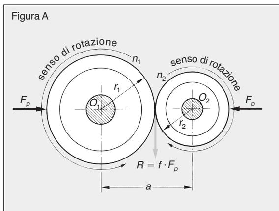
dove 1 indica la *ruota conduttrice* e 2 la *ruota condotta*.
