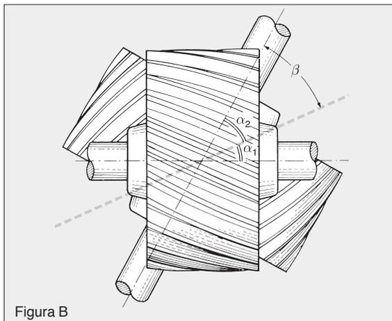
Il basso rendimento di questa trasmissione e la notevole usura delle superfici rendono questo tipo di trasmissione adatto solo alla trasmissione di piccole potenze.
