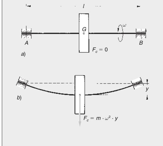
detto **velocità critica**, in corrispondenza del quale la freccia assume un valore infinito per qualunque valore dell'eccentricità.
