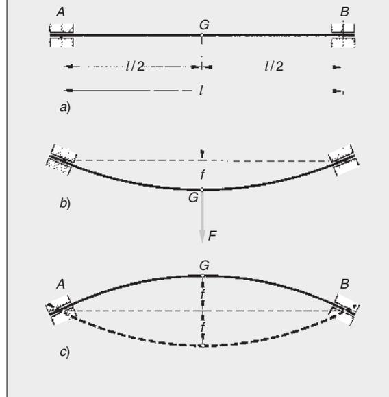
Analizziamo ora le **oscillazioni elastiche libere** di una barretta metallica vincolata ai due estremi (figura B).
