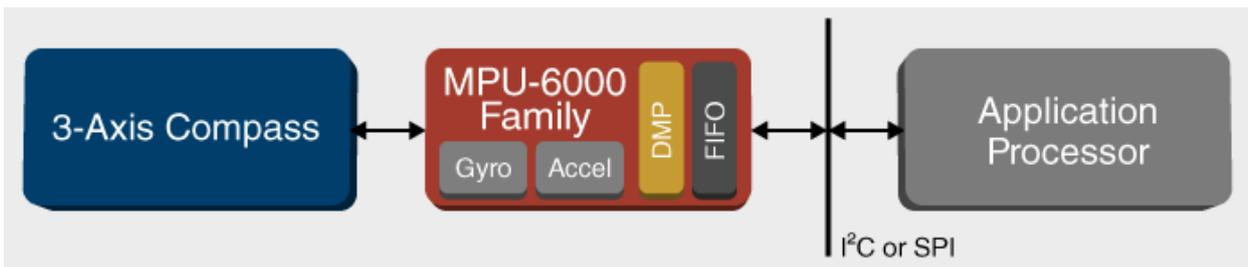
Nel chip è compreso un convertitore AD a 16 bit per ogni canale.
