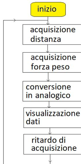
Si suppone di utilizzare un comune display LCD 16x2 (costituito da 16 colonne e 2 righe) e di riportare il la distanza sulla prima riga e la forza peso sulla seconda.
