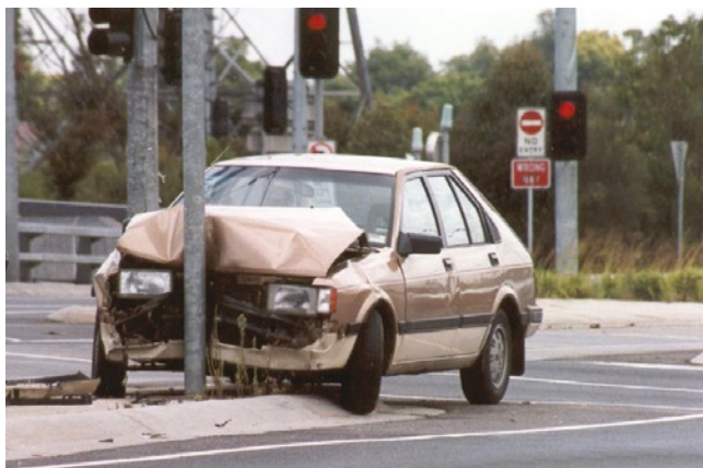
In un urto, l'energia cinetica della macchina viene spesa in un lavoro di deformazione delle lamiere.
