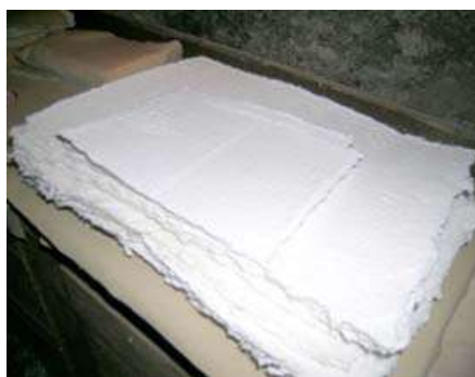
Fogli grezzi da lisciare con pestelli o raschietti.
