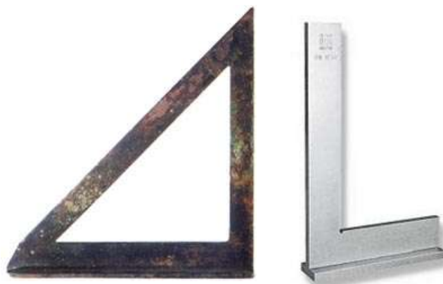
Squadre a cappello: a sinistra, squadra a cappello in bronzo di età romana (I sec. d.C.); a destra, squadra a cappello in acciaio da officina (contemporanea).
