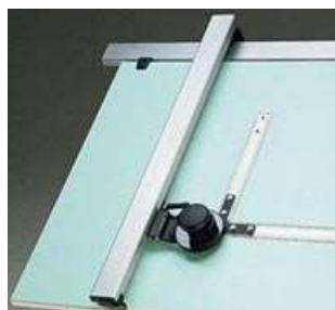
Tecnigrafi da tavolo: a sinistra, tecnigrafo a molle e contrappeso degli anni '50; sopra, tecnigrafo a rotaia degli anni '70.
