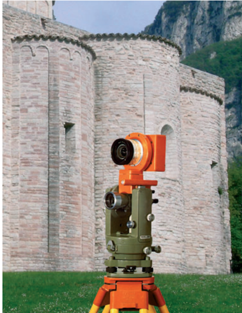
Camera fotogrammetrica sovrapposta al teodolite (Wild).
