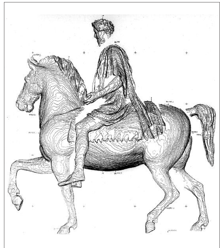
Rilievo del monumento equestre di Marco Aurelio a Roma (176 d.C.). Il rilievo fotogrammetrico per curve di livello ha consentito di realizzare al computer un modello 3D su cui si è basata la costruzione della sua copia; questa ha sostituito in Piazza del Campidoglio l'originale, conservato in ambiente protetto.
