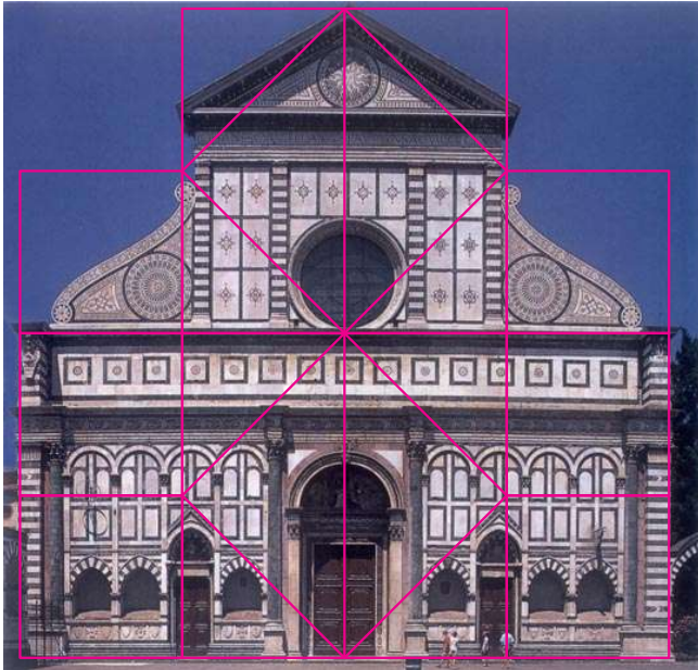
Facciata della Basilica di S. Maria Novella, a Firenze, di Leon Battista Alberti (1460). Lo schema delle proporzioni evidenzia la struttura a base quadrata, molto cara agli artisti rinascimentali.
