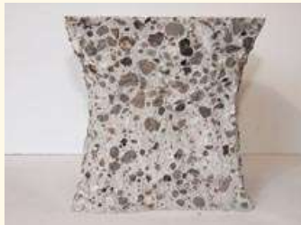
Rottura del cubo con forme piramidali.
