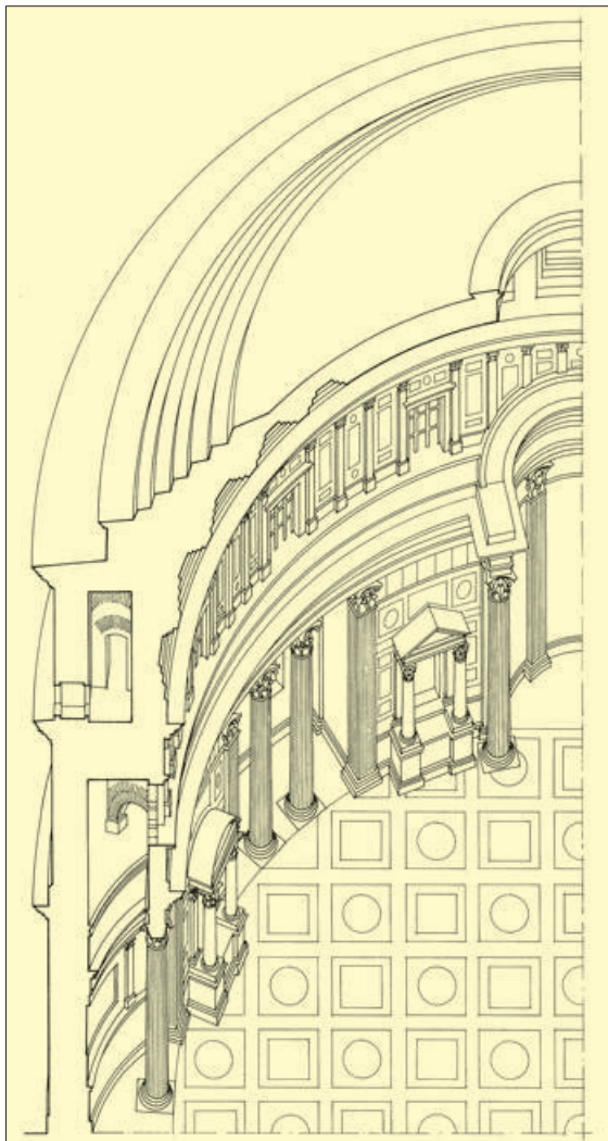
Sezione assonometrica del Pantheon a Roma, ottenuta con un piano verticale.
