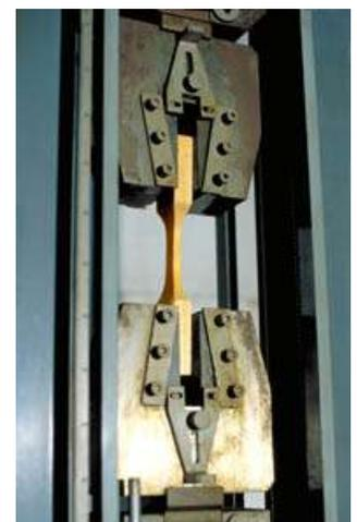
Prova di resistenza a trazione su provetta di legno.
