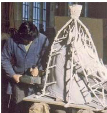
Finitura del getto con rimozione dei canali di fusione.
