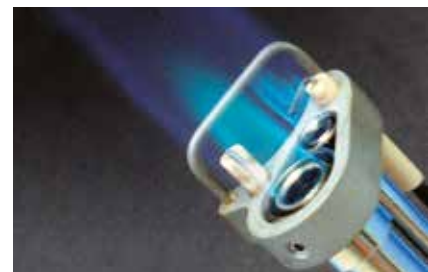
🔁 La fiamme riscaldano le termocoppie che, finché sono calde, mantengono aperta la valvola di immissione del gas. In caso di spegnimento della fiamma, la termocoppia si raffredda e comanda la chiusura della valvola.
