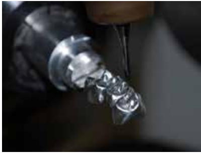
↻ Dispositivo protesico fresato in titanio , ovvero realizzato con un processo per sottrazione .
