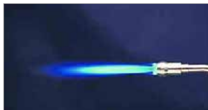
➡ Fiamma prodotta da una giusta miscela di gas. La parte da utilizzare per fondere la lega è situata a circa 8 cm dal cono azzurro brillante posto subito fuori dall'ugello del cannello di fusione. In questa posizione la fiamma è riducente e può arrivare fino a 2900 °C.
