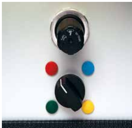
⊕ Sabbatrice a 4 sabbie, con regolatore di pressione e commutatore posti al suo interno.
