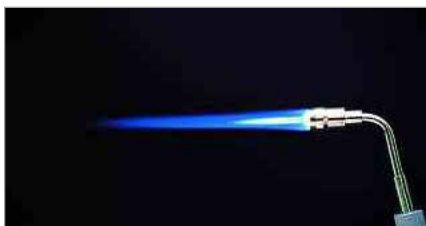
➡ Una fiamma troppo corta nella parte della corona esterna indica una presenza eccessiva di ossigeno. In questo caso la lega potrebbe surriscaldarsi e presentare porosità dopo la solidificazione.
