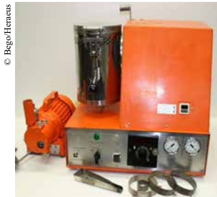
↗ A sx: schema di riscaldamento della lega per fusione elettrica. A dx: fonditrice elettrica Combilabor. In questa macchina la fusione della lega avviene a resistenza, mentre la spinta nel cilindro è data per utilizzo combinato di caduta in vuoto e pressione.
