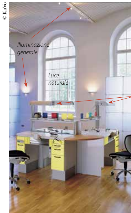
➤ I tre tipi di illuminazione generalmente presenti nel laboratorio odontotecnico.
