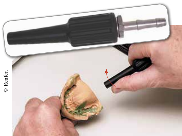
➤ Pistola ad aria compressa da banco, utilizzata per pulire le lavorazioni dalle polveri, dalla limatura ecc. Per far uscire l'aria, si deve piegare lateralmente il terminale in gomma.
