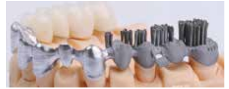
↻ ↻ Laser melting , ovvero un procedimento di fusione laser di polveri metalliche con cui si realizzano strutture con un processo per addizione .
