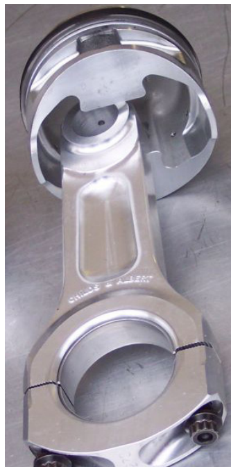
Pistone e biella in lega di alluminio.
