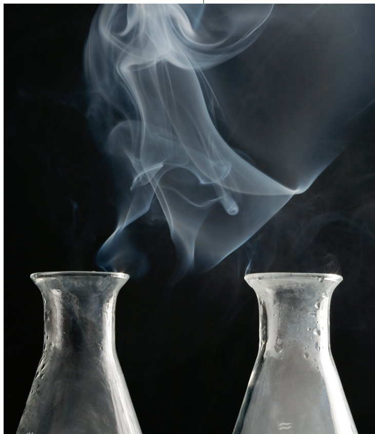
▲ Figura 1 L'acido cloridrico e l'ammoniaca che si liberano allo stato gassoso dalle rispettive soluzioni concentrate reagiscono tra loro formando un composto ionico, NH_4Cl , che costituisce la parte solida dei fumi bianchi .
