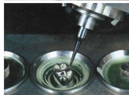
▲ Fresatura di una corona singola in titanio. Si può notare come tutto il processo avvenga per sottrazione di materiale dal blocchetto iniziale.
