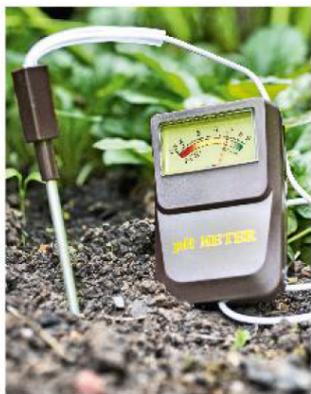
Per la misura precisa del pH possiamo usare particolari apparecchi elettronici denominati **piaccametri** o **pH-metri**, con un margine di errore di  $\pm 0,01$ .
