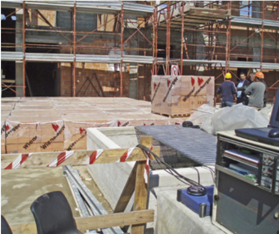
FIGURA 71 I laterizi disposti sul solaio simulano il carico di esercizio. Si noti il computer collegato al sensore che restituisce le deformazioni della trave.
